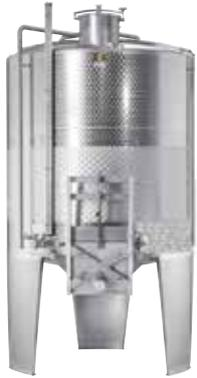
Der Speidel FD-MÜ ist ein stehender Rotweinmaische-Gärtank mit einfacher Technik, aber effektiver Wirkung: Nachdem die Gärung eingesetzt hat und ein Tresterkuchen entstanden ist, wird etwa die Hälfte des Inhaltes in einen Zwischenbehälter abgelassen. Der Tresterkuchen sinkt nach unten, bricht – und öffnet sich über ein Gestängesystem.
